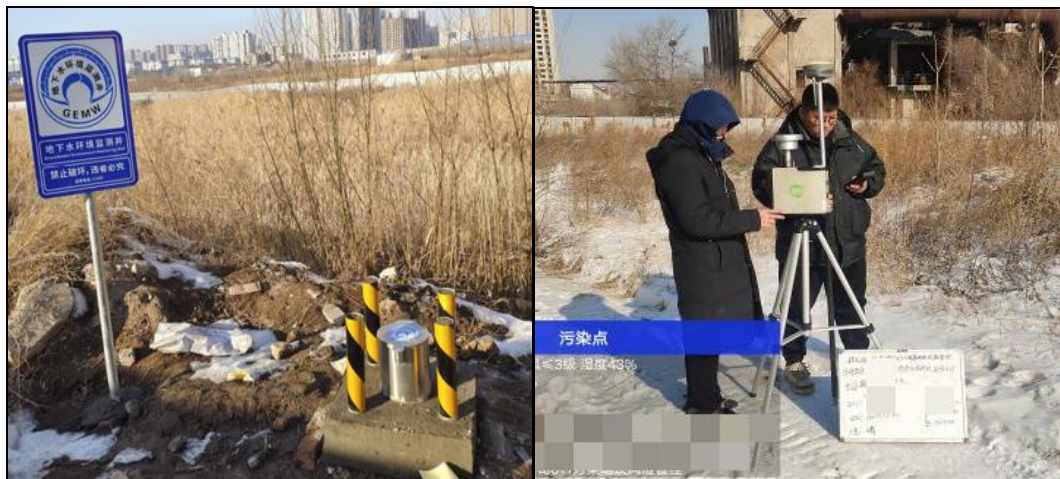
图7 地下水监测井和环境空气监测点
